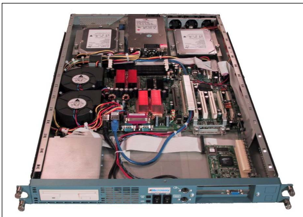
Sl. 3.9 Otvoreni računar-segment za modularnu gradnju računarskih sistema
