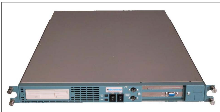
Sl. 3.8 Računar-segment za modularnu gradnju računarskih sistema
